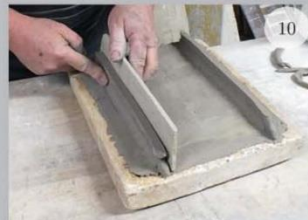
Le fortezze vengono adeguuate e incollate nel retro della piastrella
