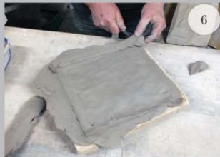
Rimozione dell'argilla in eccesso
