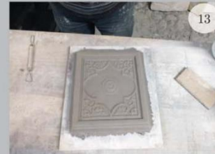
Dopo la rimozione dello stampo rimane la piastrella decorata
